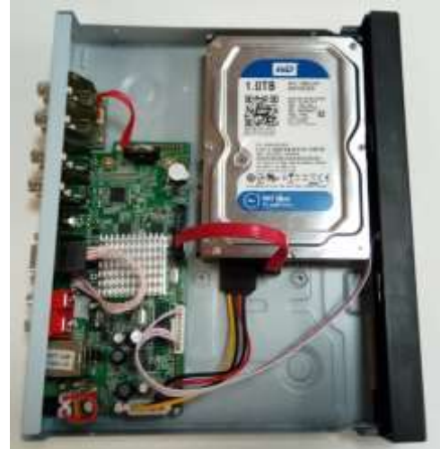
Figura 3.7 Unitate de înregistrare DVR. Montare HDD în DVR
